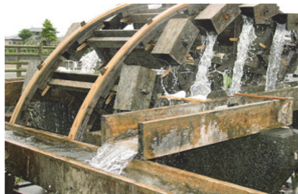
図 18 水車の仕組み (揚水)
