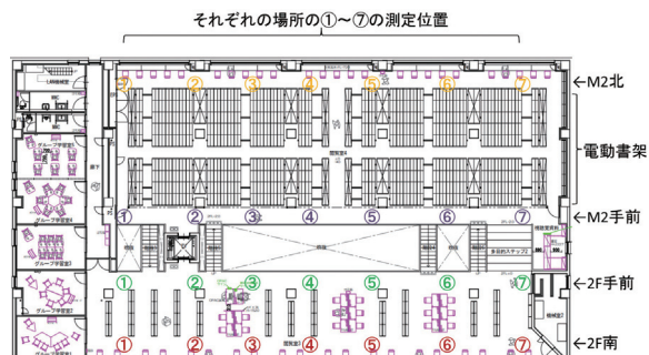
図4 電動書架の位置と騒音測定位置 2
